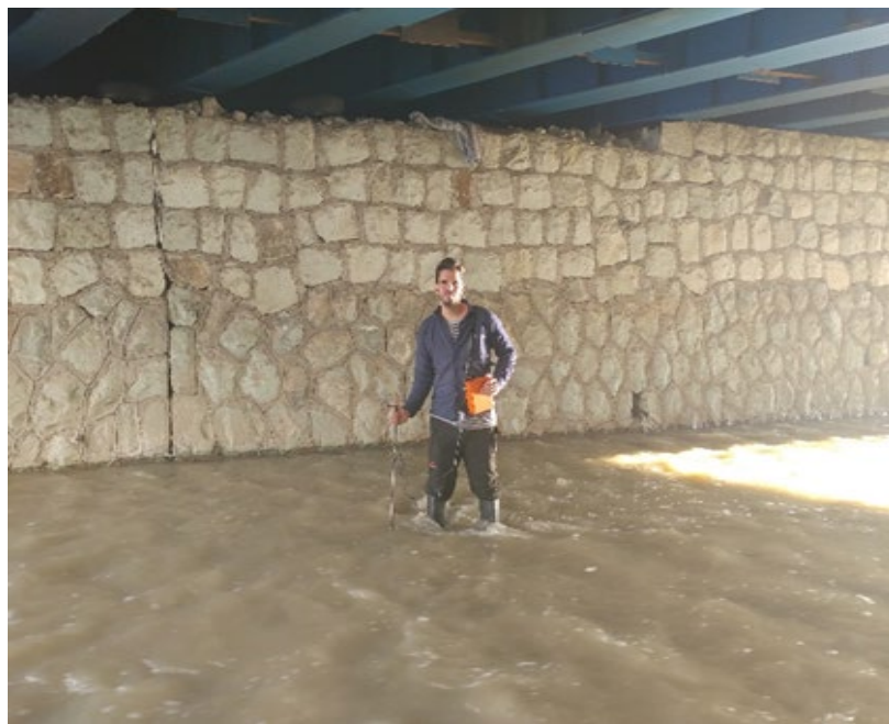
Fig. 2 Flow measurement with a mouline شکل ۲ اندازه‌گیری جریان با مولینه
