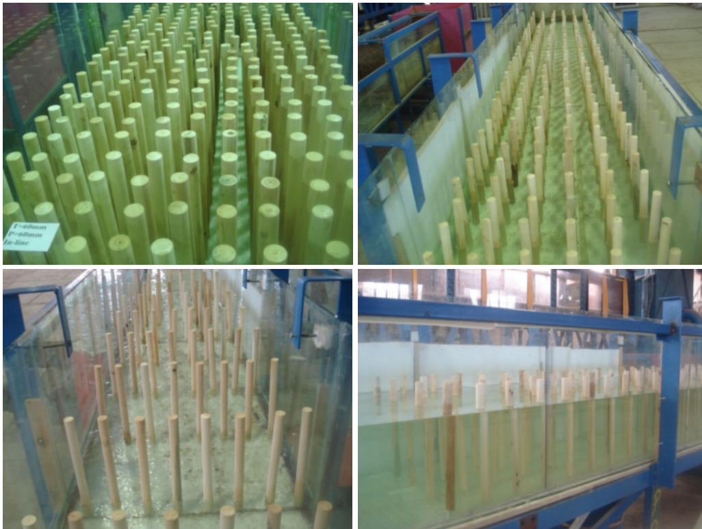
شکل ۲ چهار نمونه از نحوه نصب و آرایش موانع در فلوم آزمایشگاه
