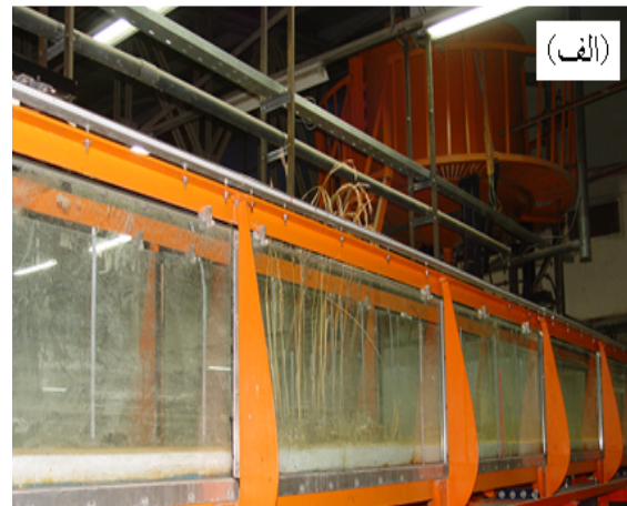
شکل ۲ الف- فلوم هیدرولیکی آزمایش ب- چیدمان گیاهان
