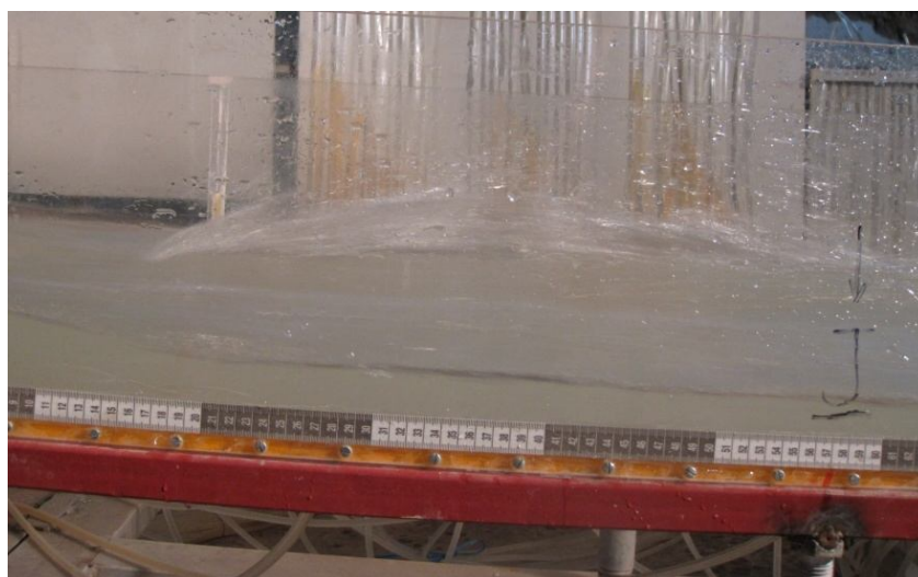
شکل 19 تصویر جدا شدن موج 2 از هسته اصلی جریان آب
