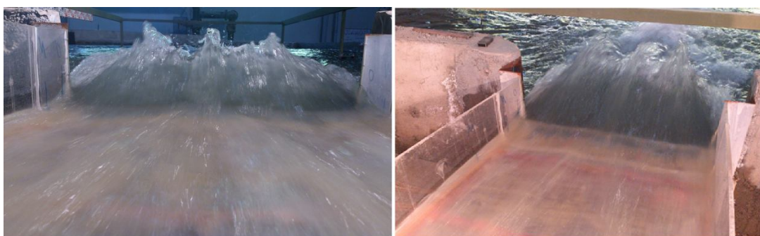
شکل 4 جت دندانهای حاصل از تداخل امواج بالای شکل روی پرتاب کننده جامی مدل حاضر
