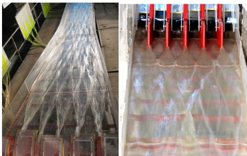
شکل 5 اشکال هندسی حاصل از امواج بالای شکل روی تنداب
