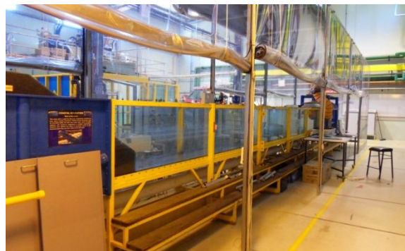
شکل 1 نمایی از فلوم موج آزمایشگاه دانشگاه گریفیث استرالیا
