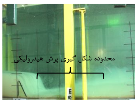
شکل 11 شکل‌گیری پرش هیدرولیکی در پایین‌دست مانع
