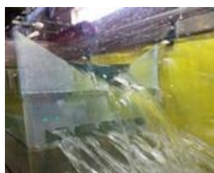
Fig. 3 Combined triangular weir used in the experiment. شکل ۳ سرریز مثلثی ترکیبی به کار رفته در آزمایش.
