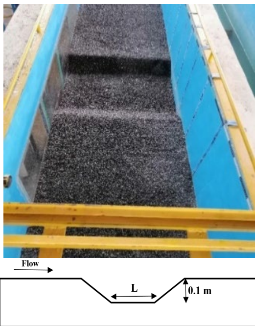
Fig. 7 Longitudinal and top view of the pit شکل ۷ نمای طولی و نما از بالای حفره
