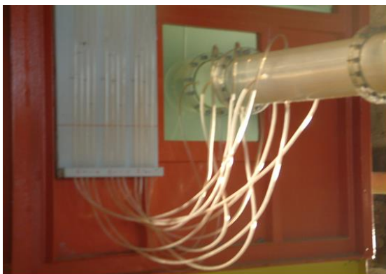
Fig. 5 Piezometers installed on the شکل ۵ پیزومترهای نصب شده بر روی مجرای آب‌بر
