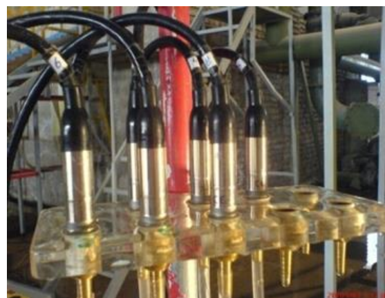
Fig. 6 Instantaneous pressure sensors in the model شکل ۶ حسگرهای اندازه‌گیری فشار لحظه‌ای در مدل
