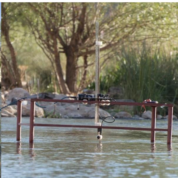
شکل ۶ میز نمونه‌گیری و نحوه استقرار دستگاه ADV در رودخانه
