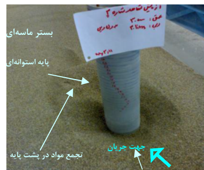
شکل ۶ ایجاد حفره در جلو و تجمع مواد در پشت پایه
