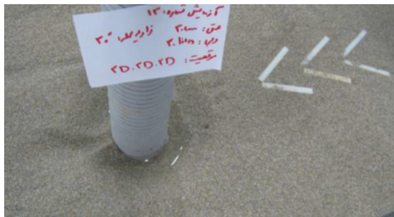
شکل ۷ نمایی از آب‌شستگی موضعی در حضور گروه پره‌ها در بالادست پایه
