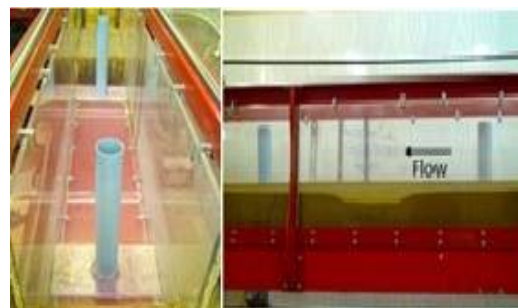
شکل 2 گودال، جهت جریان و قرار گیری پایه‌های پل در بستر متحرک
