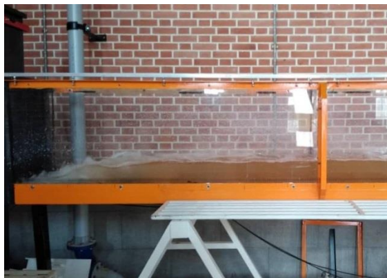
Fig.4 View of the jump formed in the trapezoidal canal شکل ۴ نمایی از پرش تشکیل شده در آبراهه دوزنقه‌ای
