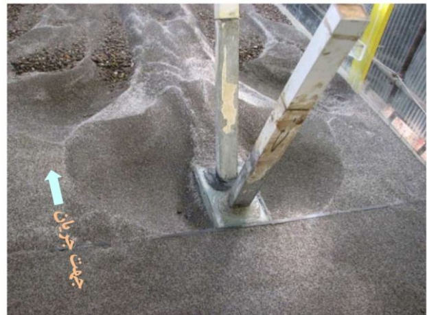
شکل 6 نمایی از چاله آبستگي اطراف پی در تراز نسبی صفر و عمق نسبی 1 و 3
