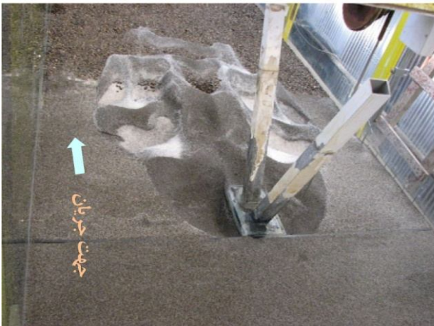
شکل 6 نمایی از چاله آبستگي اطراف پی در تراز نسبی صفر و عمق نسبی 1 و 3
