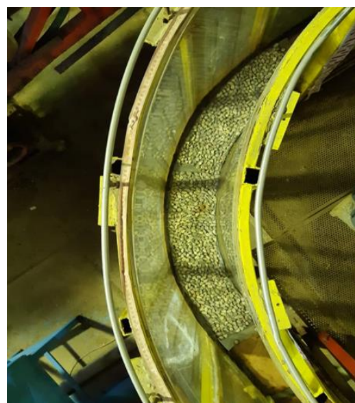
Fig. 5 View of the roughness installed in the flume شکل ۵ نمایی از زبری‌های نصب شده در فلوم
