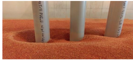
Fig. 3 Scouring sample around the base group شکل ۳ نمونه ای از آبشستگی پیرامون گروه پایه
