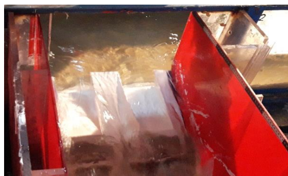
شکل ۵ نمونه سرریز با عرض ۳۰ سانتی‌متر و پایه ۱۰ سانتی‌متر
