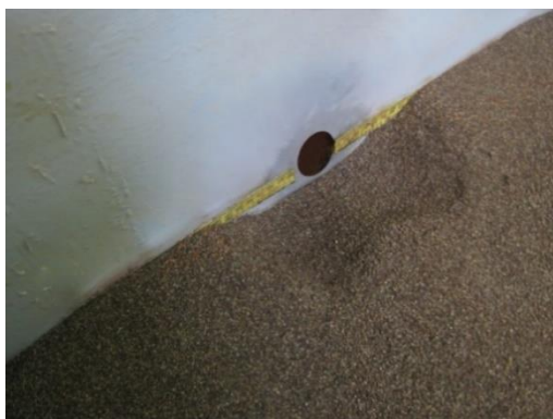
شکل ۹ مخروط رسوب‌شویی در آزمایش با سازه SFM
