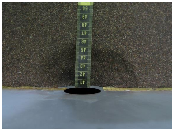
شکل ۸ مخروط رسوب‌شویی در آزمایش شاهد (بدون سازه SFM)
