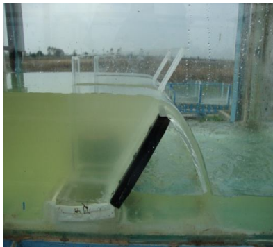
ب) نیمرخ جریان عبوری از مدل فیوزگیت شکل 7 مدل فیوزگیت خطی با نیمرخ مایل
