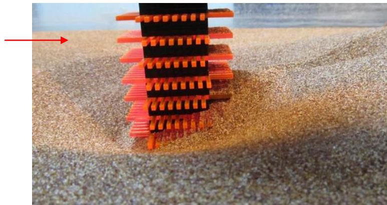
شکل 12 نمایی از پایه مجهز به زبری و نیز محل تشکیل حداکثر عمق آبشستگی در جریان با عدد فرود Fr=0.166
