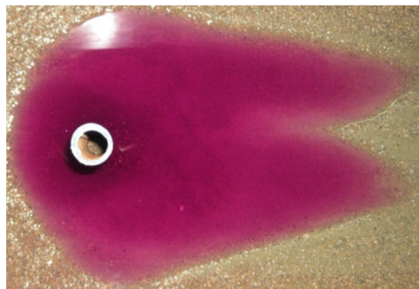
شکل ۲ تزریق مایع رنگی در داخل چاله فرسایش در آزمایش S7
