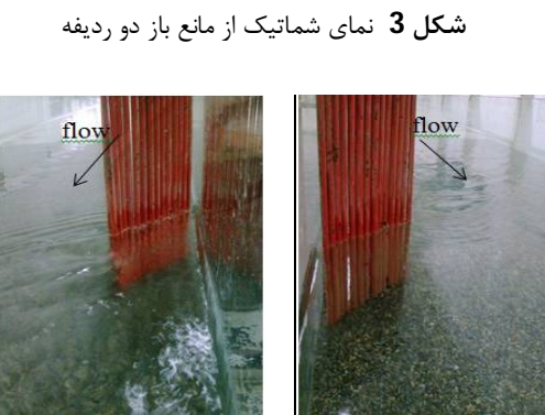
الف - مانع میله‌ای دو ردیفه زیگزگی با زاویه 45 ب - مانع میله‌ای دو ردیفه در امتداد هم با زاویه 135
