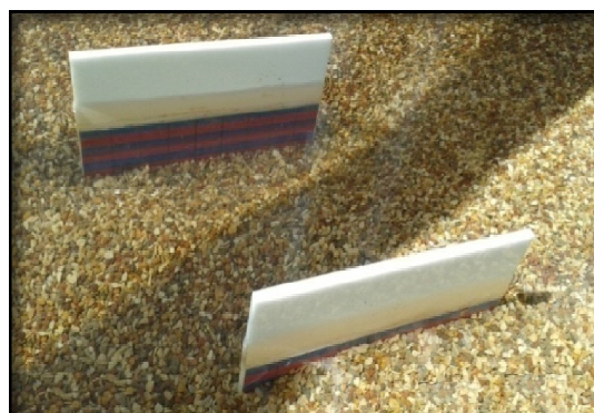
شکل 5 نمایی نزدیک از صفحات مستغرق مدرج شده و نحوه عملکرد آنها در نمایش میزان آبشستگی پای صفحات
