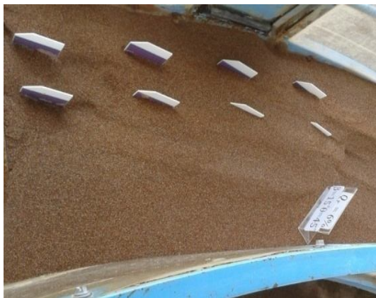
شکل 7 صفحات مستغرق در مقابل دهانه آبیگر پس از پایان آزمایش و انجام عمل زهکشی
