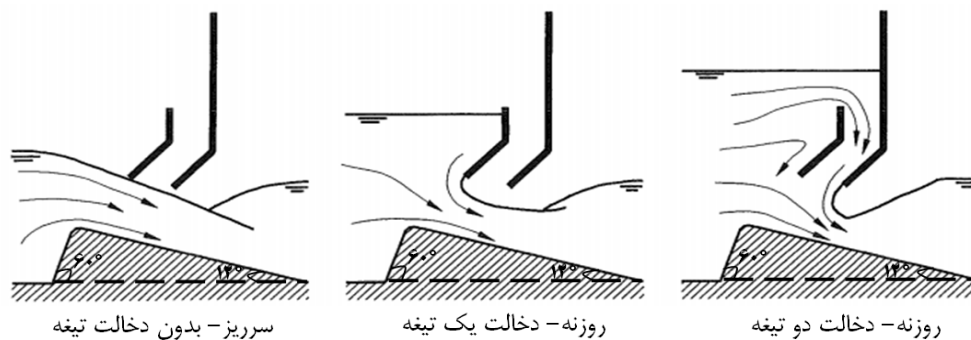
شکل 2 اصول کارکرد توزیع کننده دو نقابه نیرپیک
