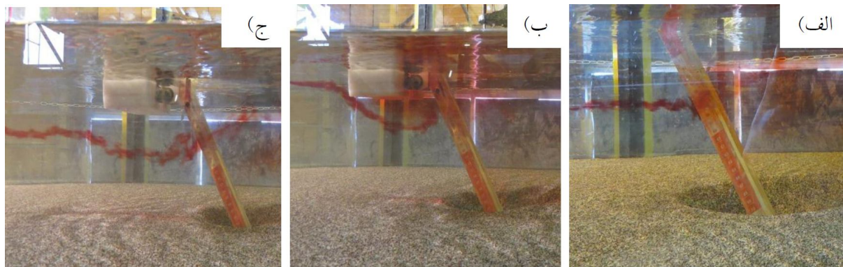
شکل 3 نمایی از آشکارسازی جریان نزدیک‌شونده به گروه‌پایه کج در حالت با و بدون جسم شناور، برای جسم شناور با ابعاد نسبی 6 \times 2 \times 1 ، y/D=5/2 و Z/D=-3 . الف) تزریق بدون جسم شناور، ب) تزریق جریان هم‌تراز جسم شناور و ج) تزریق میانی جریان
