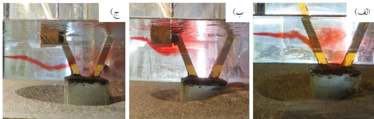
شکل 4 نمایی از آشکارسازی جریان نزدیک‌شونده به گروه‌پایه کج در حالت با و بدون جسم شناور، برای جسم شناور با ابعاد نسبی 6 \times 2 \times 1 ، y/D=5/2 و Z/D=+1/5 . الف) تزریق بدون جسم شناور، ب) تزریق جریان هم‌تراز جسم شناور و ج) تزریق میانی جریان
