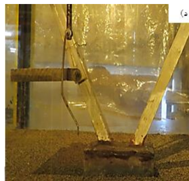
شکل 1 الف) طرح کلی فلوم آزمایشگاهی، ب) نمایی از فلوم آزمایشگاهی، ج) نمای روبه‌رو از استقرار جسم شناور، د) نمایی از استقرار گروه‌پایه و جسم شناور و ه) معرفی پارامترهای عمق آب‌شستگی در حضور اجسام شناور
