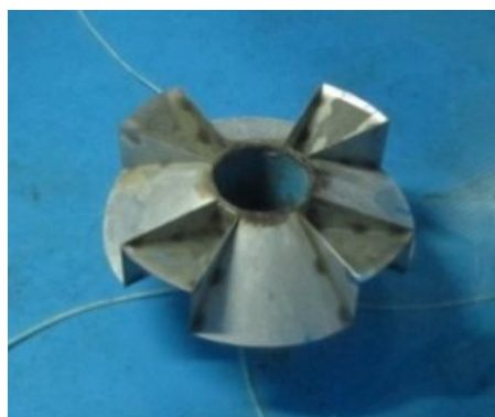
الف- مدل آزمایشگاهی ورودی کلید پیانویی ب- هندسه مدل شبیه‌سازی شده سرریز کلید پیانویی
