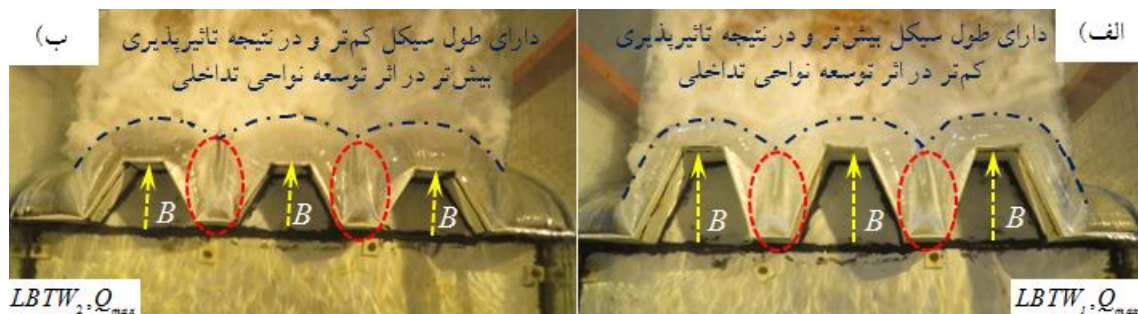
شکل 9 نمای بالای سفره‌های ریزشی جریان از روی تاج سرریز کنگره‌ای در تراز کف کانال 60 درصد برای هندسه‌های مختلف: الف) LBTW_1 ، ب) LBTW_2
