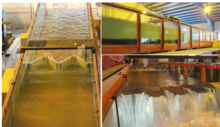
شکل 3 تصاویری از کانال آزمایشگاهی و سرریزهای مورد آزمایش
