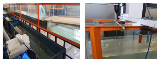
Fig. 3 A view of the laboratory channel and ADV شکل ۳ نمایی از کانال آزمایشگاهی و ADV
