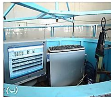
ب- نحوه اتصال سرعت سنج به کامپیوتر در داخل فلوم
