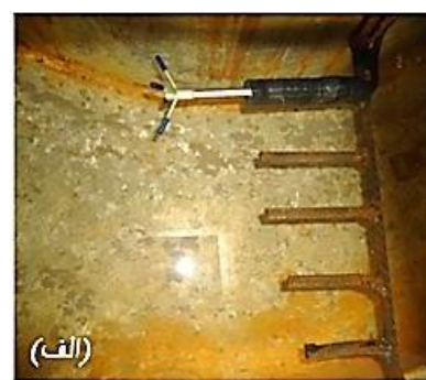
الف- نحوه قرارگیری سرعت سنج صوتی در کانال
