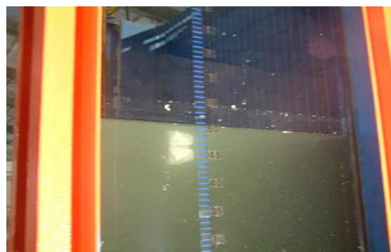
Fig. 7 Calibrated tank wall to measure water level شکل ۷ دیواره مدرج مخزن به منظور اندازه‌گیری تراز سطح آب
