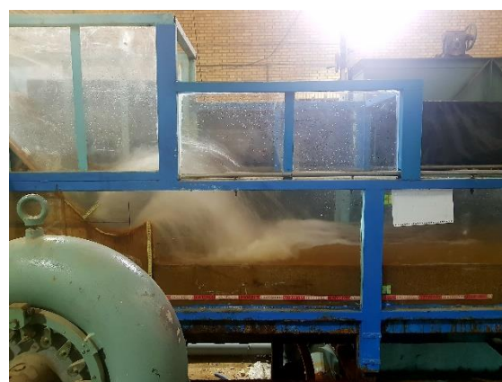
Fig. 6 A view of hydraulic jump شکل ۶ نمایی از چگونگی تشکیل پرش هیدرولیکی
