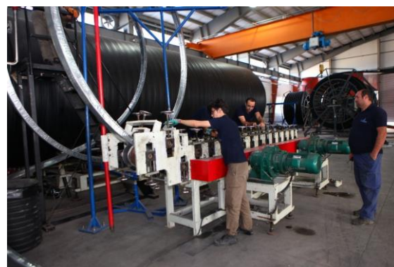
Fig. 9 Reinforced Polyethylene Pipe Production Line شکل ۹ خط تولید لوله‌های پلی‌اتیلن مسلح (SRPE)
