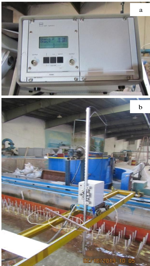
Fig. 3 a: 2-D Velocimeter, b: Bed profiler شکل ۳ a: سرعت سنج دو بُعدی، b: عمق سنج
