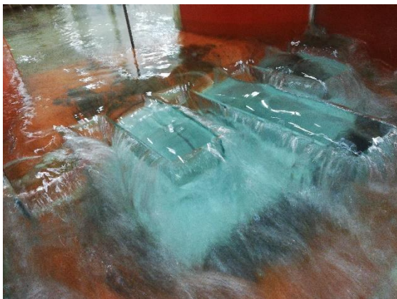
Fig. 12 labyrinth rectangular weir With unequal length of labyrinth (A1) P=10\text{cm} شکل ۱۲ سرریز کنگره‌ای مستطیلی با طول کنگره نایکسان (A1) P=10\text{cm}
