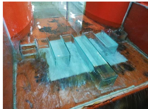
Fig. 11 labyrinth rectangular weir With unequal length of labyrinth (A3) P=10\text{cm} شکل ۱۱ سرریز کنگره‌ای مستطیلی با طول کنگره نایکسان (A3) P=10\text{cm}
