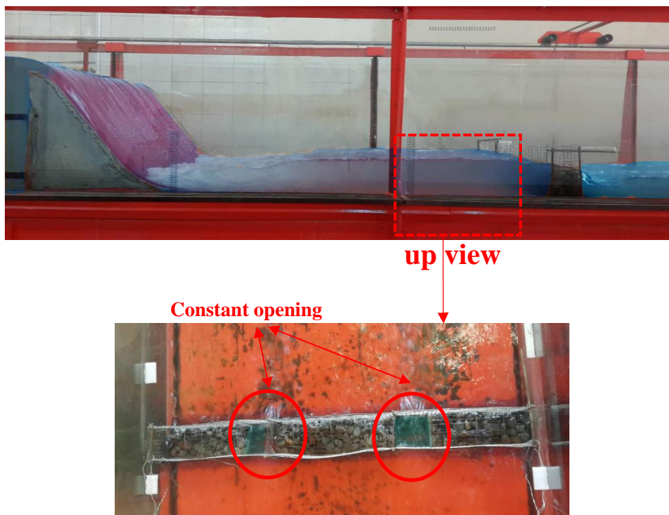
Fig. 3 View of the physical model of the Ogee series with the gabion structure at the bottom شکل ۳ نمای از مدل فیزیکی سرریز اوجی به همراه سازه گابیونی در پایین دست
