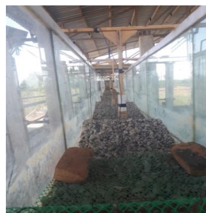
Fig.2 View of the end of flume with D1 bed-form and sensors located in the flow path شکل ۲ نمایی از انتهای آبراهه آزمایشگاهی با شکل بستر D1 و حسگرهای جانمایی شده در مسیر جریان
