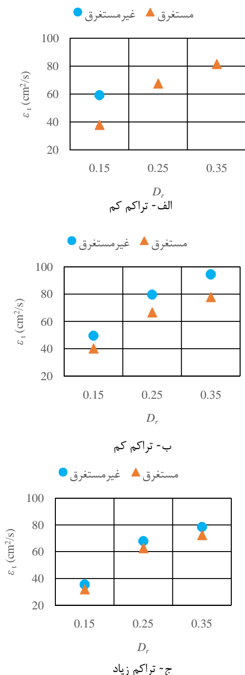
شکل 4 تغییرات ضریب اختلاط عرضی در سیلابدشت در مقابل عمق نسبی، پوشش گیاهی
