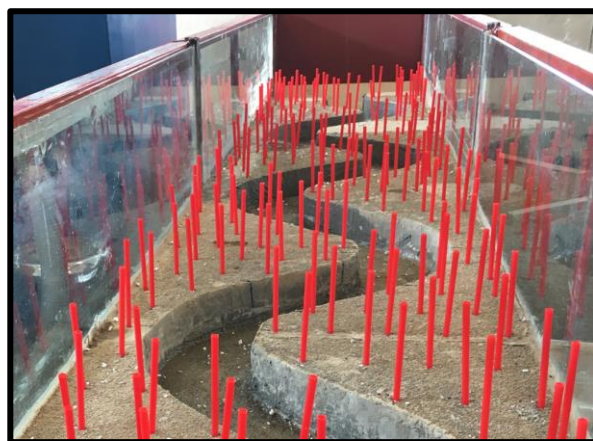
Fig. 3. Distribution of artificial vegetation, a) After being placed in canal, b) Schematic شکل ۳ نحوه‌ی قرارگیری میله‌های پلاستیکی به عنوان پوشش گیاهی (a) بعد از قرارگیری در کانال، (b) شماتیک قرارگیری
