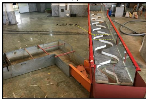
Fig. 2. a) Schematic of the main canal, b) Meander channel prepared for the experiments شکل ۲ (a) نمای کلی از فلوم اصلی، (b) آبراهه پیچانرود آماده شده برای انجام آزمایش‌ها
