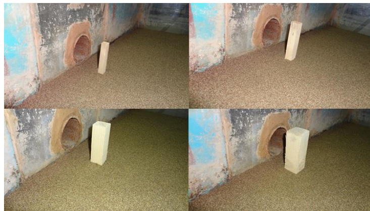
Fig. 2 Pile installation at upstream of the orifice at distance of 4.9 cm شکل ۲ کارگذاری پایه در بالادست روزنه در فاصله L_p = 4.9 \text{ cm}
