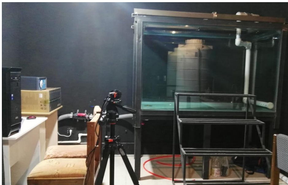
Fig.1 A photo of the darkroom, water tank, camera, laser box, and control computer شکل ۱ نمایی از اتاق تاریک، مخزن آب، دوربین، جعبه لیزر و رایانه پردازشگر مرکزی
